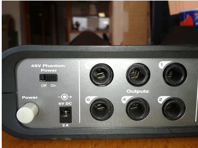
**Figura 3.1:** Interruptor del *Phantom Power*.
