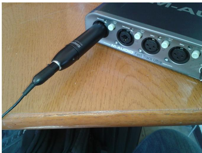
**Figura 3.2:** Conexión a canal 1.
