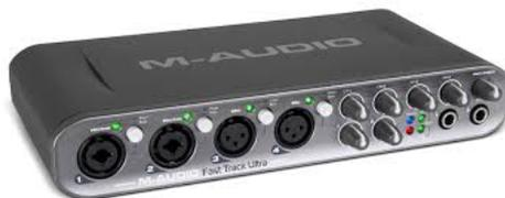
**Figura 2.4:** Interfaz de audio marca M-Audio, modelo Fast Track Ultra [10].
