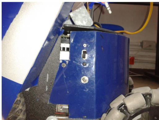
**Figura 4.3:** Interruptor de la computadora principal.
