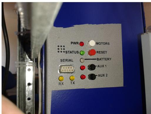
**Figura 4.2:** Interruptor de encendido y botones auxiliares.
