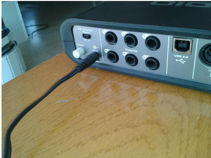
**Figura 3.5:** Conexión del eliminador a la interfaz de audio.
