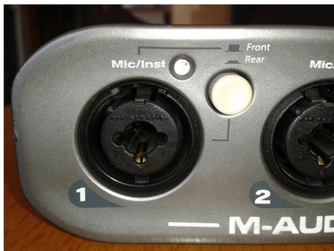
**Figura 3.7:** Botón para activación del canal frontal.
