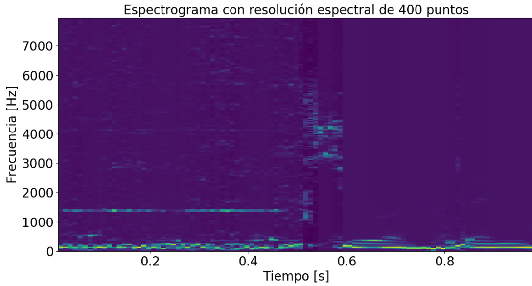
Figura 5.6: Espectrograma de frecuencias con 400 puntos de FFT.
